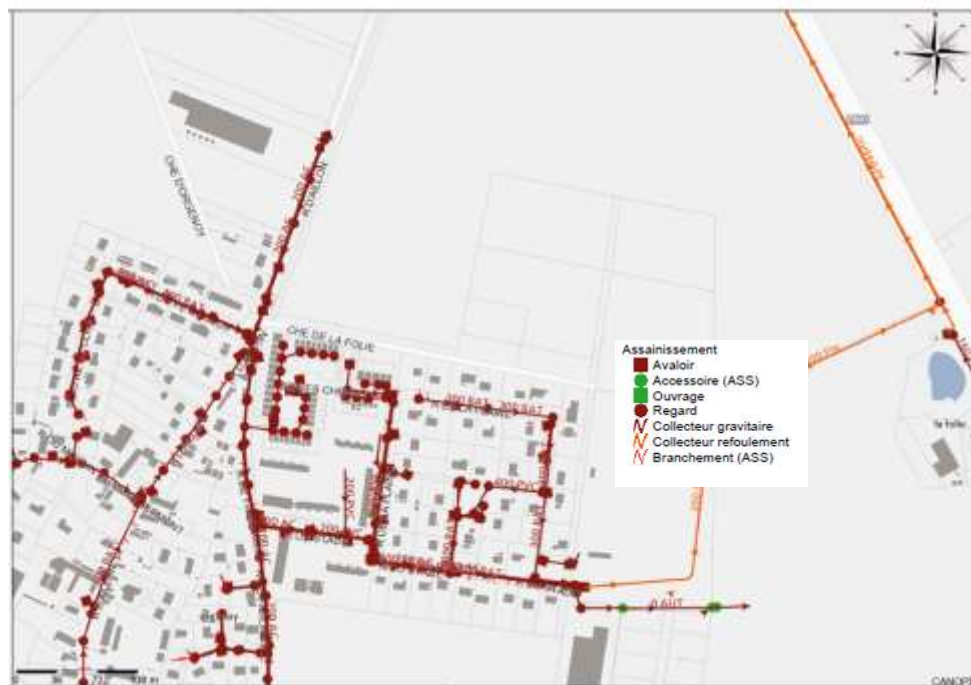
FIGURE 97 - RESEAU D'ASSAINISSEMENT (VEOLIA EAU, JUILLET 2017)
