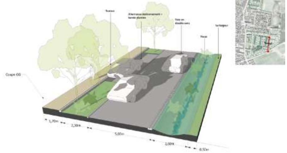
FIGURE 21 - PROFIL DES VOIES SECONDAIRES (ATELIER LD, 2018)
