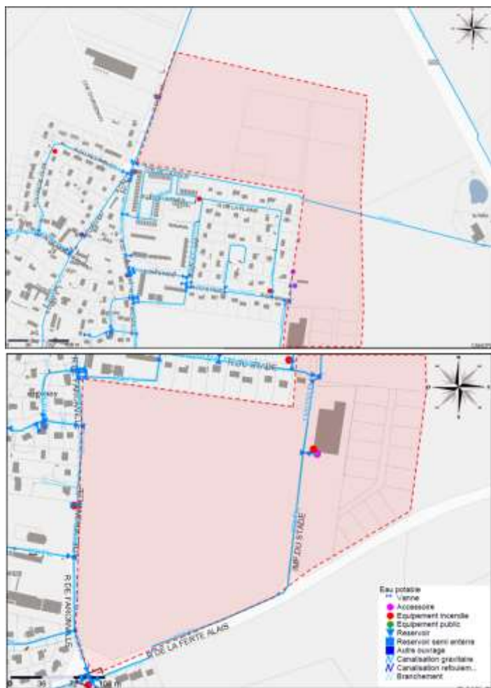
FIGURE 96 - RESEAU EAU POTABLE (VEOLIA EAU, JUILLET 2017)
